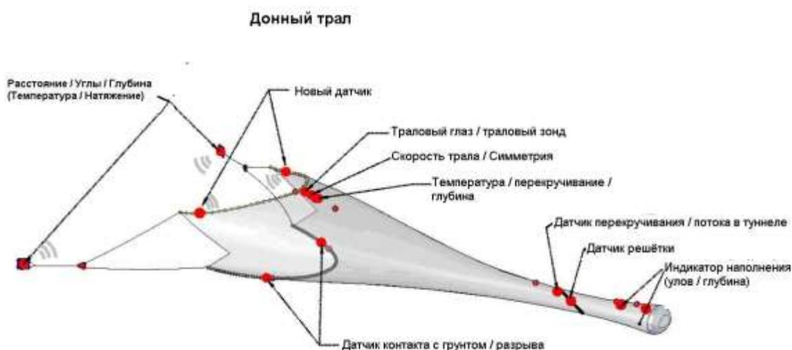
Первоначально базовая система контроля лова, созданная 25-30 лет назад, включала в себя датчик высоты верхней подборы, Траловый глаз/Траловый зонд, датчики расстояния между досками и простые датчики глубины, температуры и улова. Мы получаем отзывы от рыбаков со всего мира, и нет сомнения, большинство из них очень довольны результатами работы с системами Сканмар.
