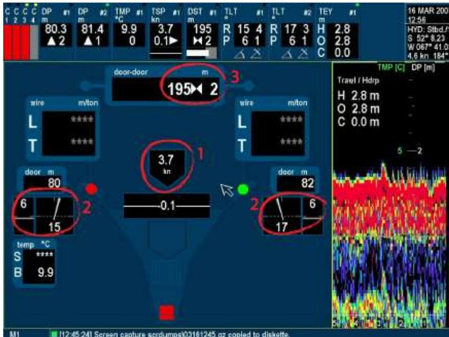
(1) Сниженная скорость трала приводит к тому, что (2) доски опрокидываются внутрь и (3) расстояние между ними снижается.
