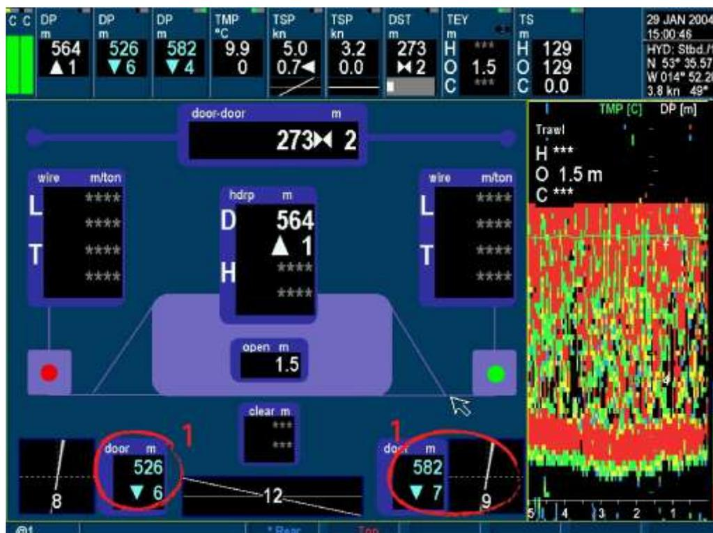
*Сильное течение, влияющее на траловые доски (1) заставляет их идти под разным наклоном и на разной глубине.*
