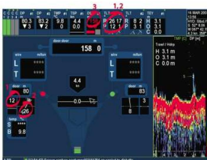
Левая доска теряет контакт с грунтом, трал теряет горизонтальное раскрытие. (1+2) Большие углы крена и дифферента приводят к нестабильному ходу доски и потере контакта с грунтом. (3) Доски опрокидываются и теряют контакт с грунтом.
