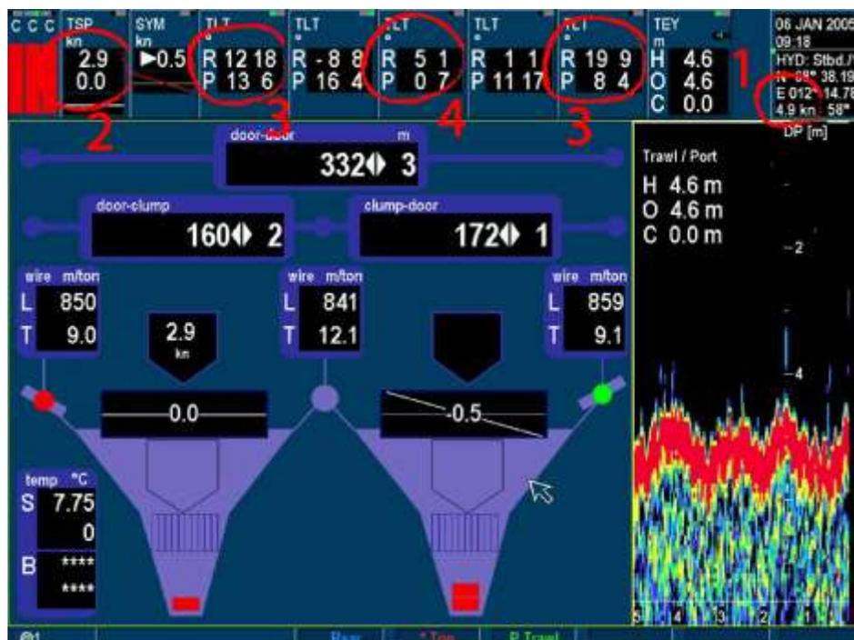
Лов ведётся при очень сильном течении (1): GPS 4.9 узла., (2) TSP 2.9 узла. Это нарушает стабильность досок (3), но двойной трал и грунтотрп оказывают сильное давление на грунт (4), позволяя сохранять контакт
