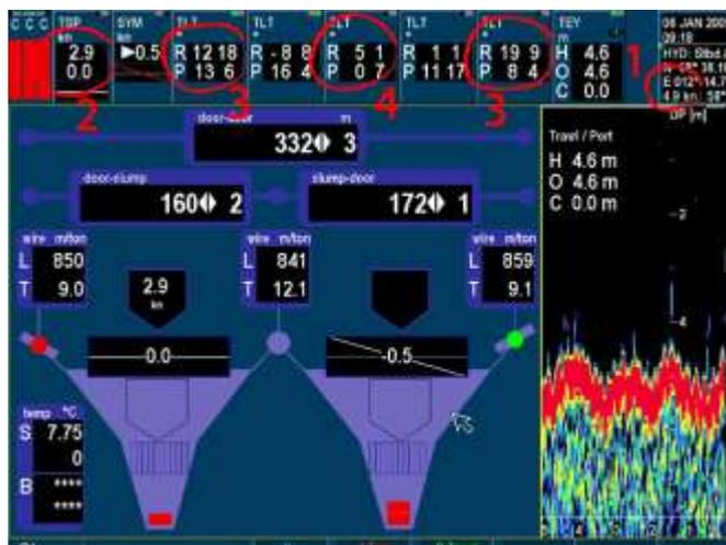
Лов ведётся при очень сильном течении (1): GPS 4.9 узла., (2) TSP 2.9 узла. Это нарушает стабильность досок (3), но двойной трал и грунтотроп оказывают сильное давление на грунт (4), позволяя сохранять контакт
