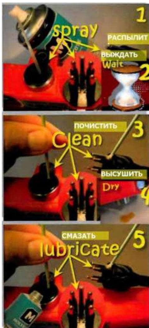
1. Используйте очиститель контактов Molycote S-1002 (баллончик с пластиковой трубкой) для смачивания контактов разъёмов тралового глаза, батареи и зарядного устройства. В батарейном разъёме полностью смочите гнезда.
